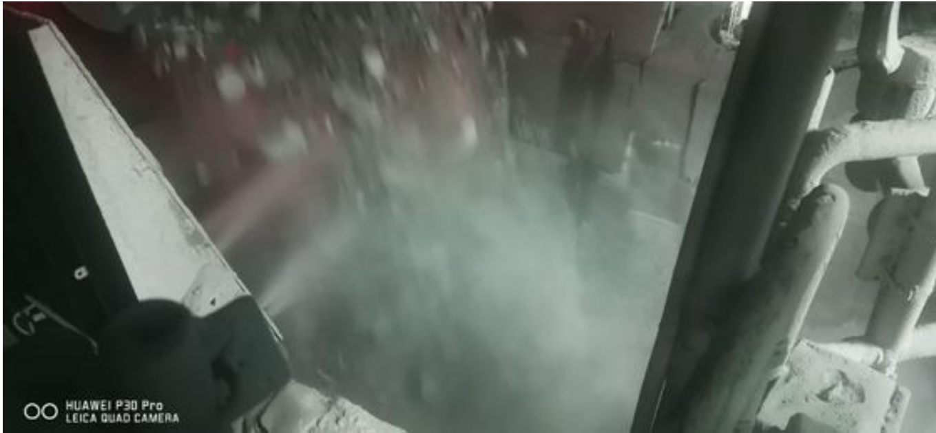
Foto 15: Medida: Supresor de polvo. Lugar: Taza Chancado 1. Comentarios: Supresor de polvo Chancado1 operativo. Se observa material particulado en suspensión. Medida de mitigación no es suficiente.
