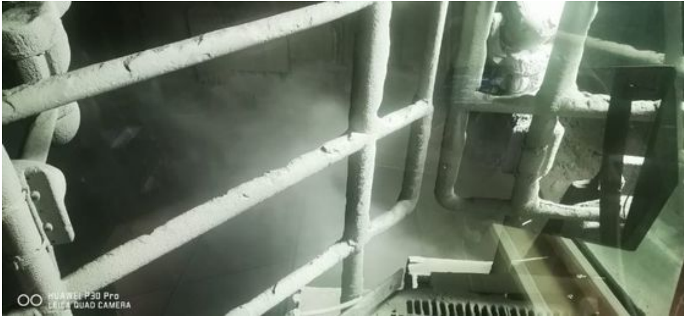
Foto 14: Medida: Supresor de polvo. Lugar: Taza Chancado 1. Comentarios: Supresor de polvo Chancado1 operativo. Se observa material particulado en suspensión. Medida de mitigación no es suficiente.
