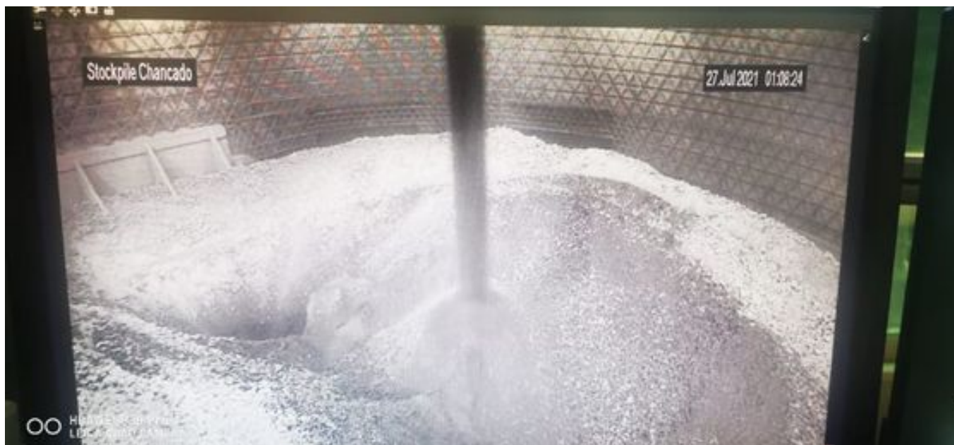
Foto 18: Medida: Espumante en Correas y Stock Pile. Lugar: Chancado 2. Comentarios: Espumante en Correas y Stock Pile Chancado 2 operativo. Stock de producto TK 4.050 litros. Ambas bombas al 20% operativas.
